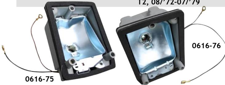
En dehors des verres de clignotant, nous avons maintenant aussi en vente les supports d'ampoule de clignotant pour le Type 2, 08/'72-07/'79. Le support d'ampoule n'est souvent pas remplacé, parce qu'il y a moins d'usure. Cependant il est important que la douille soit en bonne état afin d'éviter des problèmes électriques. Ici aussi nous avons choisi le meilleur qui est disponible au marché, ce qui est Volkswagen original. Vendu la pièce pour 1 côté avec joint. Le stock est déjà disponible.
