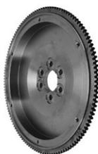
Este volante está hecho de un volante motor de Audi 80 pero lleva la corona de un escarabajo moderno de 120 dientes y va con motor de arranque de 12 Voltios. También hace falta montar un disco de embrague de 215 mm ref. 1545 este volante se monta sin problemas sobre el motor del Golf. Y así se monta sin problemas en la caja de cambio de un escarabajo.
