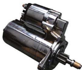
Este motor de arranque tiene muchas ventajas con respecto a el de origen. Tiene una potencia de 1,4KW contra los solo 0,7 KW que tiene el de origen, asi que puede con motores de mas compresión. Su peso también es menor sólo 2KG, así que es ideal para la gente que busca ganar peso para coches de competición.
