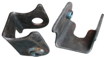
Si tienes un escarabajo 1200/1300 con suspensión de tipo trompetas y quieres tener un comportamiento mejor en curvas. Puedes montar estos anclajes y colocar la suspensión IRS de un 1303/02, o montar una caja de cambio automática.
