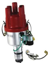
Si haces una reforma al motor, el delco 009 es una pieza que no te puede faltar (obligatorio) Este delco es centrífugo y no lleva pulmón de avance, la curva de encendido es mucho mejor que la del delco de origen. Gracias a esto tendrás mejor combustión. El 009 también sirve como recambio para el delco de origen cuando este roto o desgastado. Para los que quieren uno con aún más 'chicha' tenemos el 050 (ideal para motores Drag)
