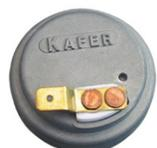
**2145-1** Choke de recambio para carburador 6V
