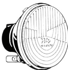
B. Óptica H4 Se acopla igual que el Sealed Beams 7 inch. Esta óptica se puede usar para muchas cosas también vale para otro tipos de coches americanos.
