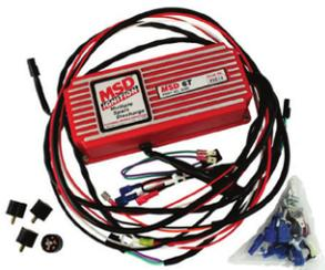
Esta caja de encendido es la misma que la 6AL pero con la diferencia que tiene una protección interior líquida denominada en la USA como HUM1. Por su particular protección interior este encendido se usa mucho en las carreras de OFF-ROAD. Encima tiene 4 conexiones externas para montar un cuenta vueltas que corta el encendido (en el salpicadero) (mira la ref. 2000-15 y 2000-16).
