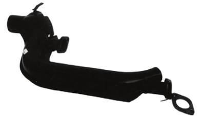
**1080-1** Calefactor izquierdo, con diametro interior Ø 35 mm, con puente del lado del escape
