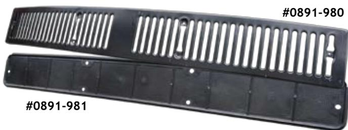
Dieses originale Gitter und das Schutzgitter (Plastik) werden an die Frontmarke angezogen. Sie sind von Volkswagen Brasilien und passen perfekt beim Typ 2 van 1973 bis 1979 einschließlich. Das Gitter aus Metall ist in schwarze Grundfarbe gespritzt. Nach Jahr und Tag sind Gitter und Plastik gerostet oder zerbrochen und weil es ziemlich schwierig ist solche Stücke zu machen, ist es viel einfacher diese neu zu montieren. Sie werden das Stück verkauft und der Stock ist schon vorrätig.
