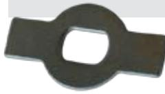
Dieser Sicherungsring ist zurück zu finden unter dem Feder des Ausstellfensterscharnierstifts beim T2, '50-'67. Er wird zur Sicherung der untersten Montagemutter verwendet. Bei der Restaurierung des Ausstellfensters ist er durch die Demontage unvermeidlich beschädigt worden und soll er ersetzt werden. Der Sicherungsring ist VW Brazil original und werden das Stück verkauft. Der Stock ist schon erhältlich.
