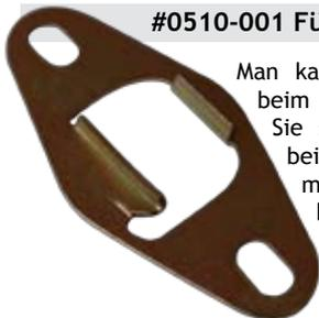
Man kann diese Platte unter den Schalthebel beim T1, '72-'79 und T2, -'71 zurückfinden. Sie sorgt für die Führung des Schalthebels beim schalten wodurch vorkommen wird das man den falschen Gang selektiert. Falls sie beschädigt ist, wird der Hebel nicht gut mehr geführt, was für Schaden an der Führung zwischen Halter und Getriebe oder in extremen Fälle am Getriebe selbst. Ab heute können wir sie original und das Stück aus Stock liefern.
