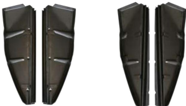
Diese Dreiecksbleche sind zurück zu finden im Motorraum links und rechts vom Motor gegen den Innenkotflügel. Sie sorgen für den Anschluß der Karoserie gegen dem Motorblock, wodurch keinen Schmutz oder Staub in den Motorraum reinkommt. Auch verstärken diese Bleche das hintersten Teil unseres beliebten VW Käfers. Ab heute können wir diese Bleche mit der korrekten Profilierung und Paßform in einer ausreichenden Qualität, das Stück aus Stock liefern. Modell 60-67 folgt...
