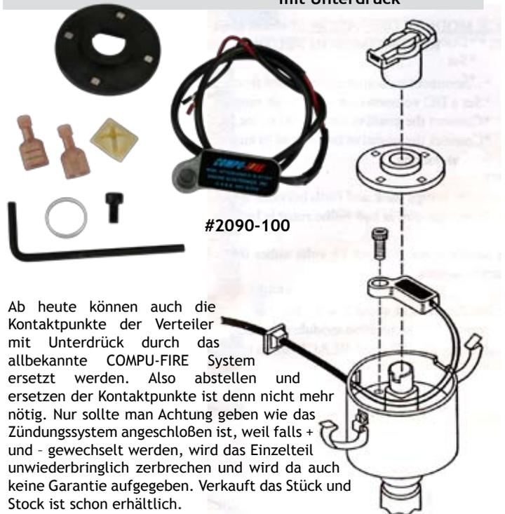
Ab heute können auch die Kontaktpunkte der Verteiler mit Unterdrück durch das allbekannte COMPU-FIRE System ersetzt werden. Also abstellen und ersetzen der Kontaktpunkte ist denn nicht mehr nötig. Nur sollte man Achtung geben wie das Zündungssystem angeschlossen ist, weil falls + und - gewechselt werden, wird das Einzelteil unwiederbringlich zerbrechen und wird da auch keine Garantie aufgegeben. Verkauft das Stück und Stock ist schon erhältlich.
