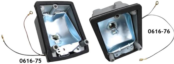
Außer die Blinkergläser haben wir jetzt auch das Gehäuse für die Blinker des Typs 2, 08/'72-07/'79 in Stock. Das Gehäuse ist manchmal nicht ersetzt worden, weil da weniger Abnutzung sitzt. Jedoch ist es wichtig das die Lampenfassung in einem guten Zustand ist um elektrischen Probleme zu vermeiden. Auch hier haben wir für das Beste was auf dem Markt erhältlich ist, vorgezogen und es ist Volkswagen original. Verkauft das Stück per Seite mit Gummi. Stock ist schon erhältlich.
